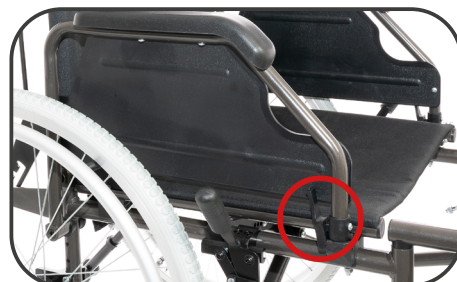
Ilustracja 21. Dźwignia blokady odchylenia podłokietników.
