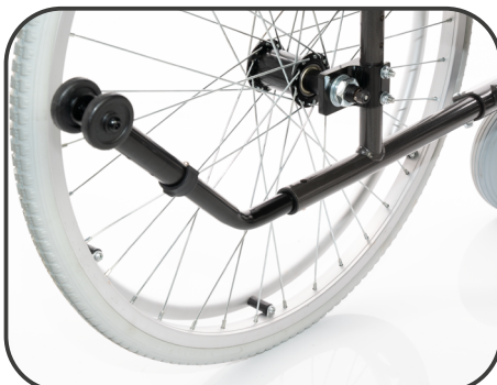
Ilustracja 28. Kółka antywywrotne obrócone do góry.
