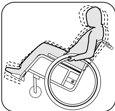
Ilustracja 30. Znalazienie punktu krytycznego przechyłu wózka.
