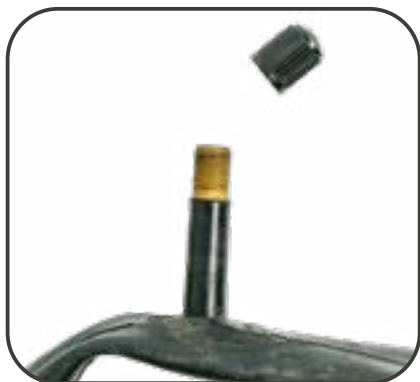
Ilustracja 14. Zawór „Schradera” (samochodowy)
