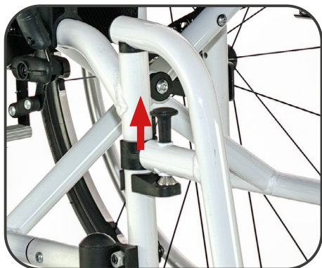
Ilustracja 5. Blokady podnóżków. Należy pociągnąć do góry w celu odblokowania obrotu podnóżka.
