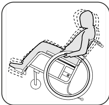
Ilustracja 20. Znalazienie punktu krytycznego przechyłu wózka.
