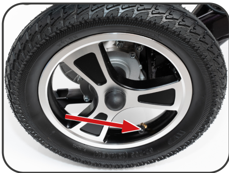
Ilustracja 22. Zawór „Schradera” (samochodowy)
