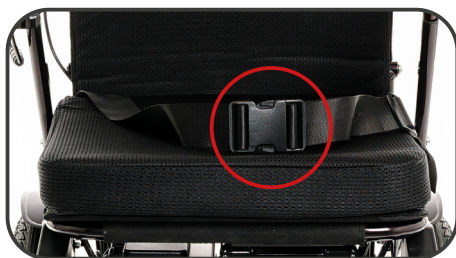
Ilustracja 19. Prawidłowo zapięty biodrowy pas bezpieczeństwa.
