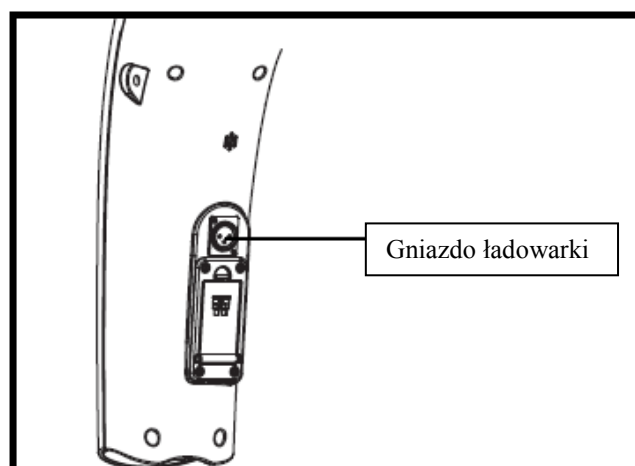
Rysunek 6. Gniazdo ładowarki na kol. kierowniczej
