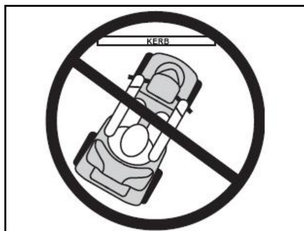
Rysunek 3A. Nieprawidłowy sposób pokonywania progów.
